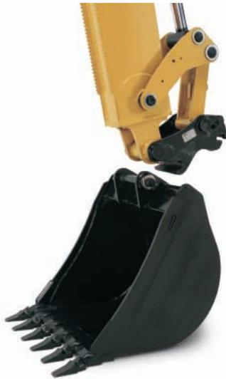
*Cucharón para excavación de suelos con acoplador*
