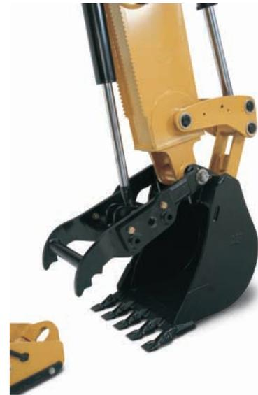
**Montaje de tenaza.** Los elementos necesarios para el montaje de tenazas son estándar en toda Retroexcavadora Cargadora Cat para añadir versatilidad a la máquina. Las tenazas hidráulicas están disponibles para su instalación en fábrica.
