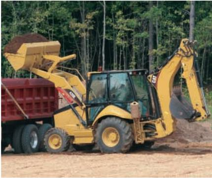
**Varillaje del cargador de inclinación sencilla.** El varillaje del cargador de inclinación sencilla ofrece grandes fuerzas de levantamiento y separación para obtener un rendimiento consistente en aplicaciones de relleno y carga de camiones. La máquina se equipa con un cucharón de uso general o con uno de uso múltiple para adaptarse a sus necesidades específicas.
