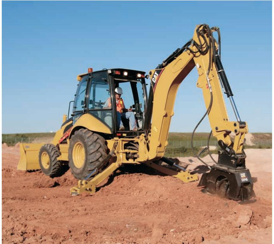
**Tacos reversibles de los estabilizadores.** Tacos reversibles de los estabilizadores que proporcionan la capacidad de trabajar en aplicaciones de manipulación de tierras o en las carreteras. Nuevos tacos con caucho de alta resistencia al desgaste que proporcionan un mecanismo anti-volcadura efectivo.
