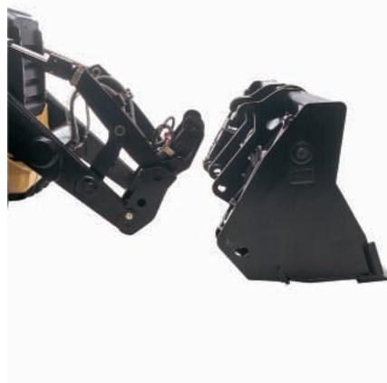
**Acoplador rápido del cargador.**
